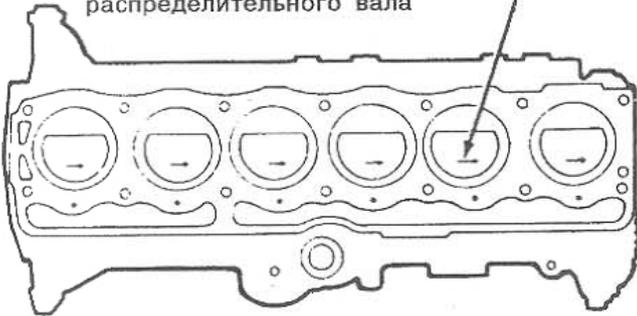
При установке поршней с шатунами в цилиндры направить стрелку «Б» на днища поршней в сторону привода распределительного вала
