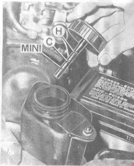
Проверка уровня масла в бачке гидроусилителя рулевого управления
