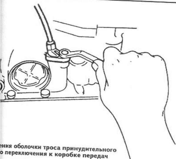
Регулировка оболочки троса принудительного обратного переключения к коробке передач
