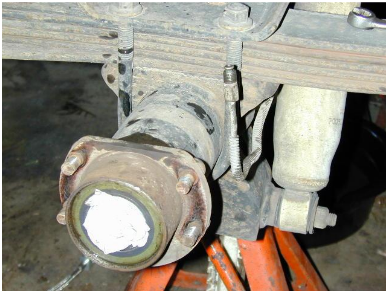
Исходные отверстия для крепления тормозного щитка меньше чем для 8.25. Рассверливаем их дремелем
