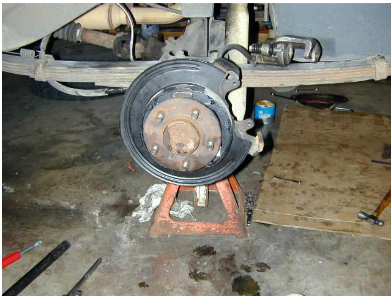
Окончательная сборка ...Осталось прокачать тормоза (сделать кровопускание /сленг/) и настроить ручник.
